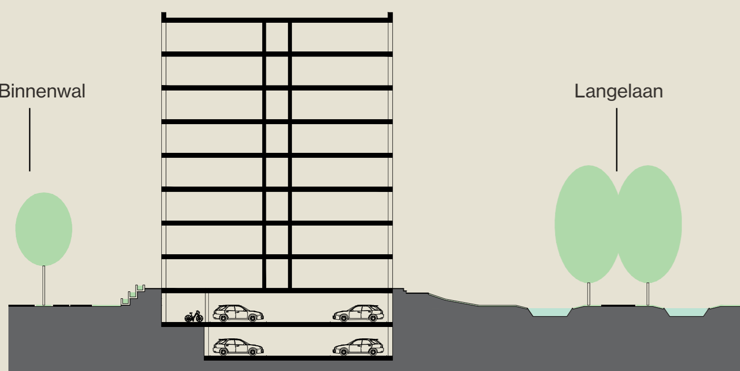
principe doorsnede parkeren onder gebouw
